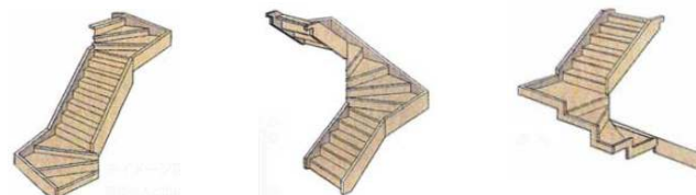
Type1: 箱型・廻り階段 Type2: 箱型・折り返し階段 Type3: 箱型・折り返し階段
